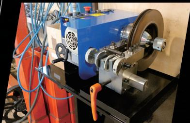
ブレーキのディスクローター研磨機
